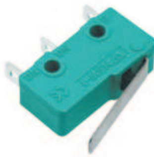
Obrázek 4.2: Ukázka mikrospínače, zdroj: TME [29]
